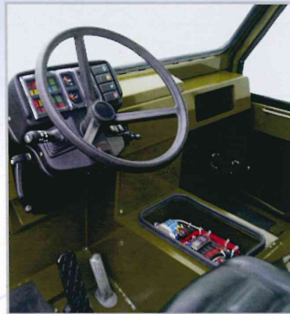
Coffret électrique Electrical box
